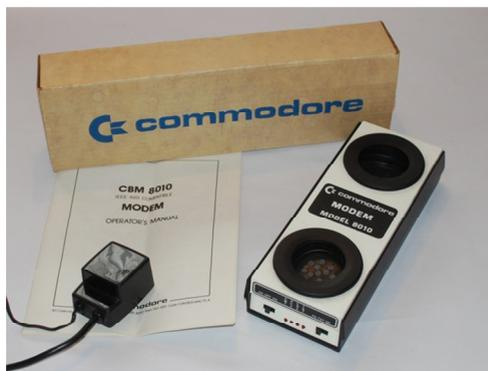
Abb. 2: Akustikmodem zur Datenübertragung
